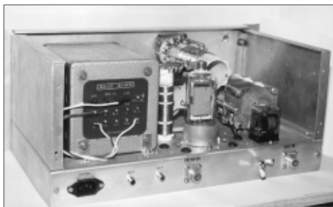
Foto 4. Vista posterior del amplificador, con la tapa posterior y el ventilador retirados para mostrar los detalles del circuito de placa.
